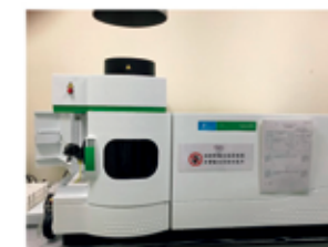
感應耦合電漿發射光譜儀 - 質譜儀
