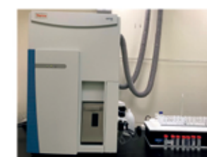
感應耦合電漿發射光譜儀 - 質譜儀
